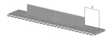
In caso di nastri larghi si raccomanda una o più interruzioni dei facchini per permettere il piazzamento delle guide di sostegno sul tratto di ritorno.
